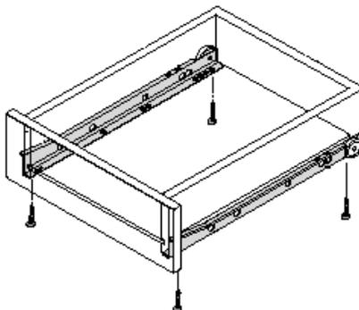
9. На фасадной стенке винтом М4х20 закрепить ручку. Закрепить фасад к передней стенке, ввернув винты М6х25 в установленные в фасадной стенке гайки.
